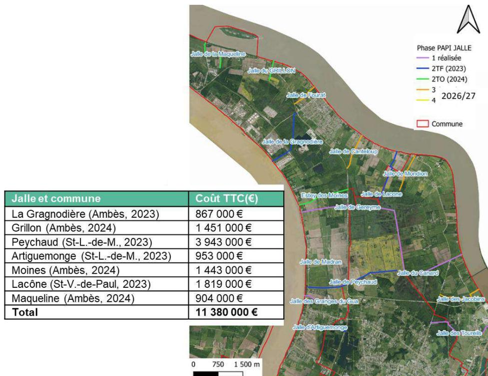
Figure 1 : Phasage et coût de la restauration du réseau hydraulique de la presqu'île d'Ambès
